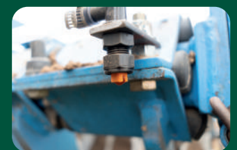
› Sprühleiste mit handelsüblicher Düse an Bestandsmaschine
